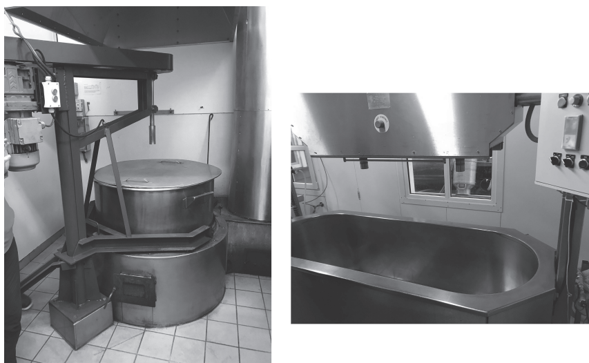
図4 ノルウェー、中小規模生産者の設備 左：ブラウンチーズ濃縮機（200 L），右：チーズバット（500 L） 2018年 筆者撮影
